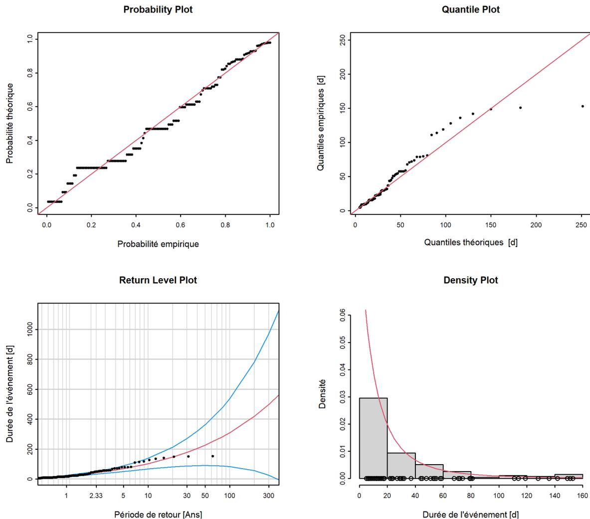
FIGURE 12 – Graphiques diagnostiques de la variante du modèle “ stat ” de la méthode POT (01.07.1958 - 30.06.2020)
