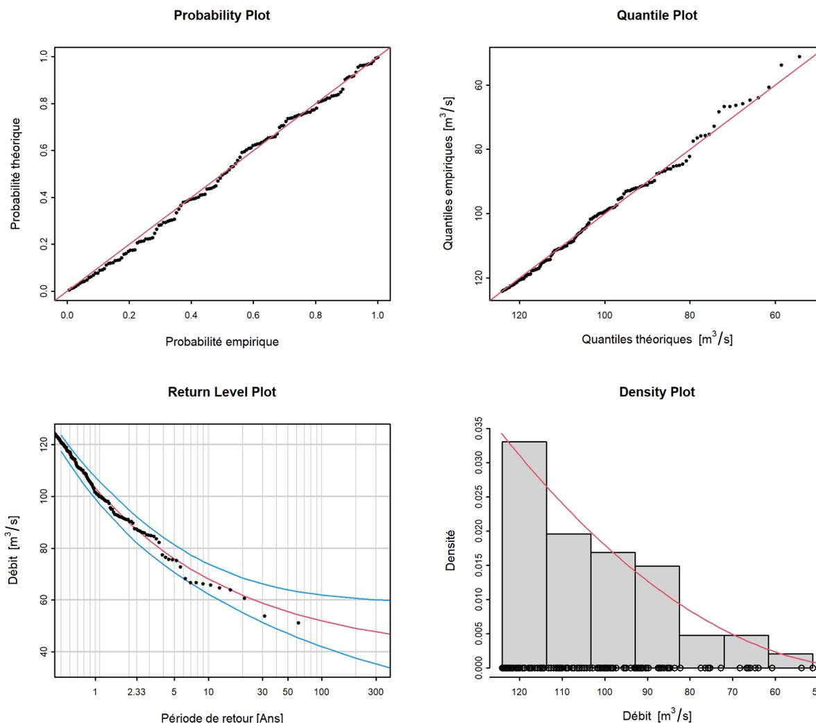
FIGURE 9 – Graphiques diagnostiques de la variante du modèle “ stat ” de la méthode POT (01.07.1958 - 30.06.2020)
