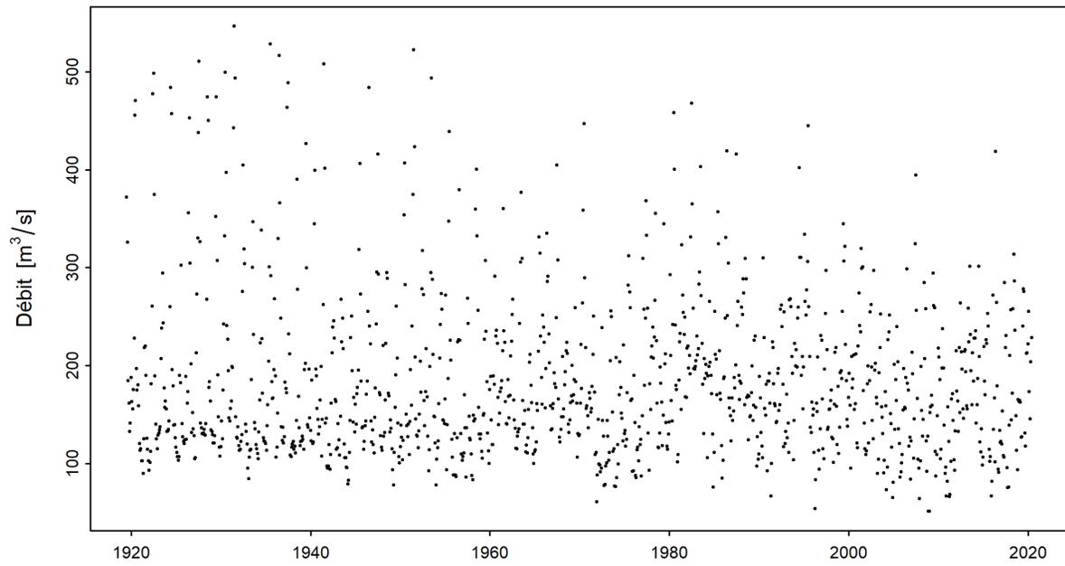
FIGURE 3 – Série temporelle du minimum mensuel de M7Q [ $\text{m}^3/\text{s}$ ] (01.07.1919 - 30.06.2020)
