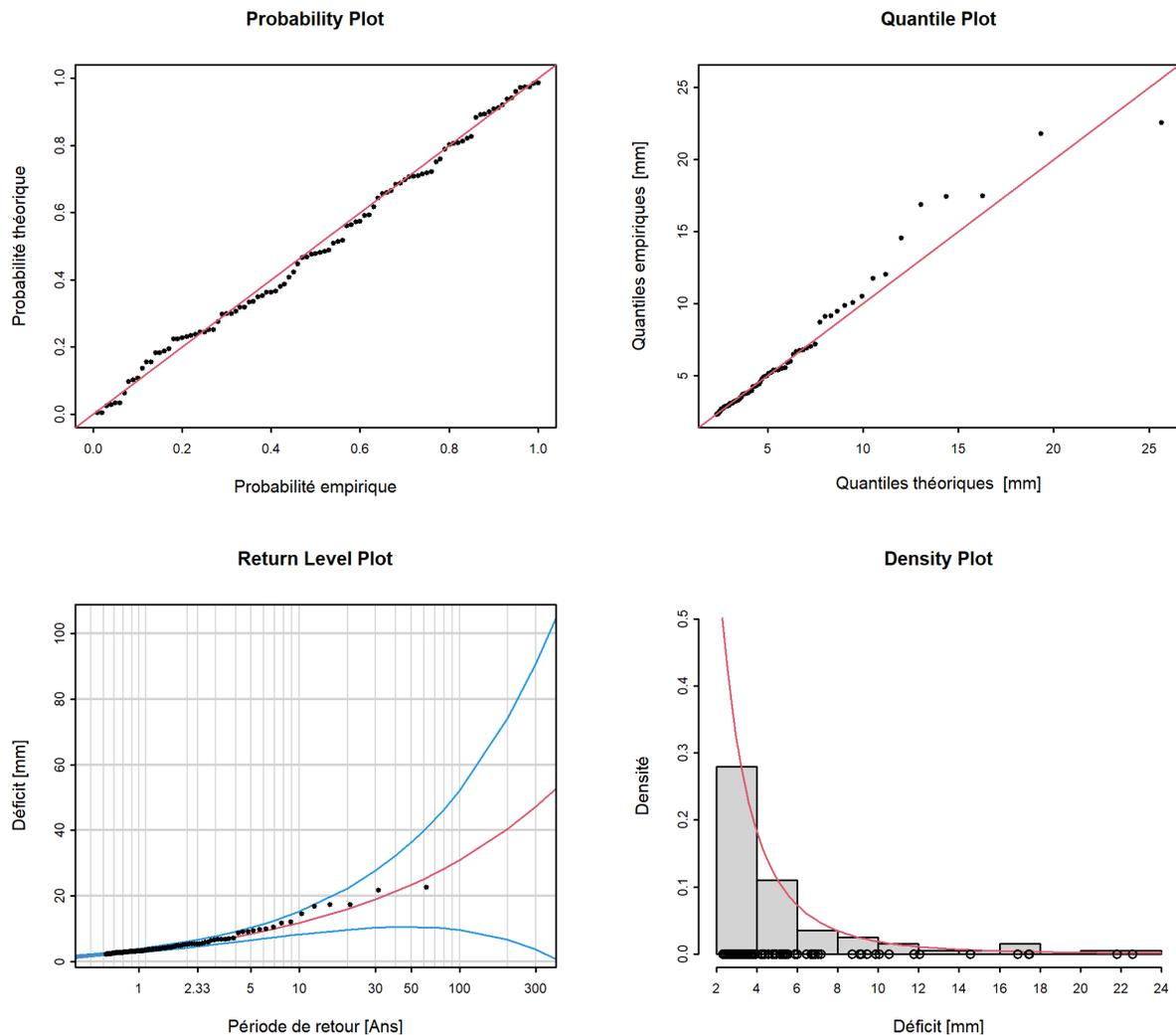
FIGURE 14 – Graphiques diagnostiques de la variante du modèle “ stat ” de la méthode POT (01.07.1958 - 30.06.2020)
