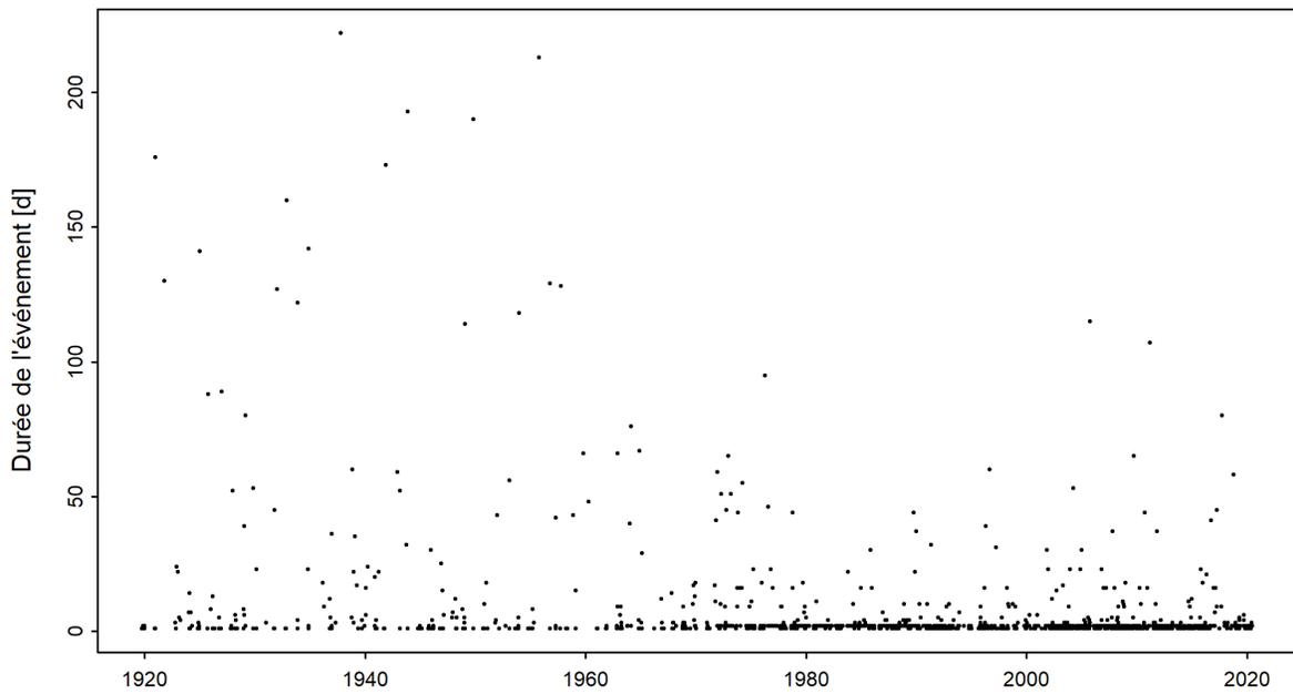
FIGURE 4 – Série temporelle des durées d'étiage [d] (01.07.1919 - 30.06.2020)
